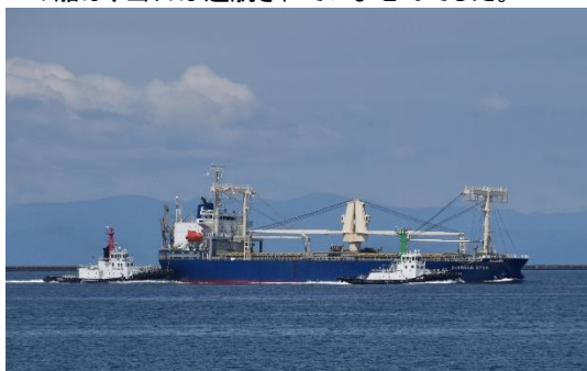
入港してる貨物船「ダイヤモンド・スター」です。荷役装置として回転式クレーン 2 基とデリック 2 基をもっています。2 隻のタグボートが付き添っていました。
